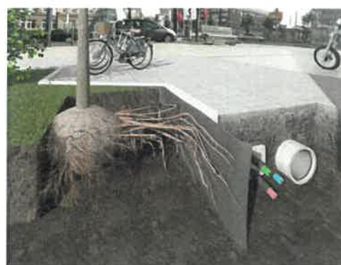
รูปที่ 2.17-9 ตัวอย่างรายละเอียดแผ่นป้องกันราก (Root Barrier)
