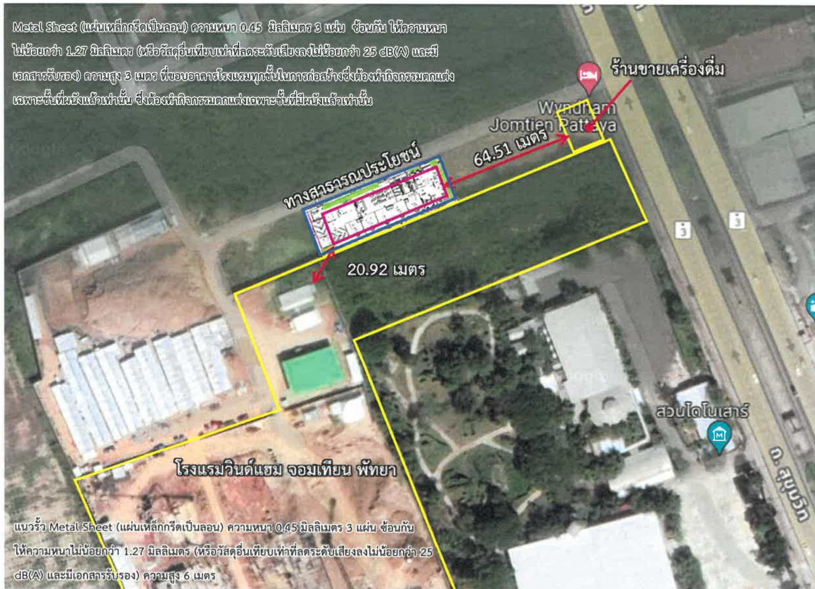
รูปที่ 4.1.5-6 ผังแสดงแนวรั้ว Metal Sheet ที่เป็นกำแพงกันเสียงโดยรอบโครงการในช่วงงานโครงสร้าง
